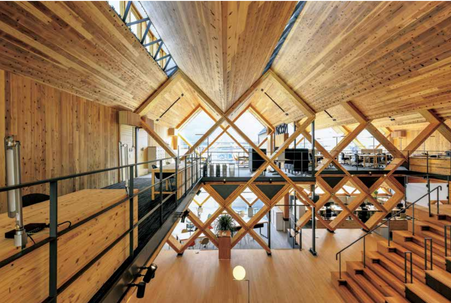
銘建工業本社事務所の内観。CLTのV型の梁と折板屋根は菱組架構の集成材で支えられ、トップライト部分は鉄骨ラチスで接合されている [写真：すえひろフォトスタジオ・野上仙一郎]
