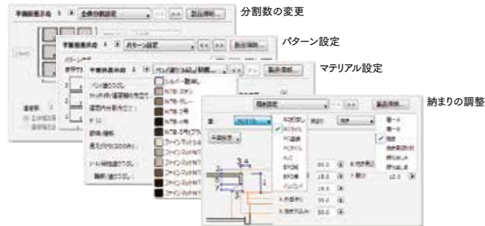
[図5] 独自編集機能による自由な窓のモデルの作成 (ビルサッシ・カーテンウォール)
