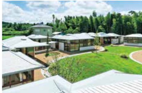
おむかいさん (2015/上) 千葉県木更津市に建つ知的障害者支援施設。構造・設備・家具が一体となった「傘ユニット」を25カ所に配置し、6人居住の住まい3軒とその間の共用棟を構成している。家具のように設えられた傘ユニットは、周囲に居場所をつくり出すとともに採光の経路でもあり、屋根裏に溜めた暖気を床下に送り込む環境装置としても機能している【写真：西川公朗】
