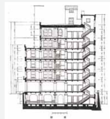
日証館断面図：当時の図面によると、2,249本の松杭の上に基壇状に見えるコンクリートの桶をつくり、浸水を防ぐために防水を施し、その中に地下1階、地上6階、鉄筋コンクリートの建物を建設した。昭和3年[1928]建設、設計は横川工務店、施工は清水組。【出典：『東京横浜復興建築図集』】
