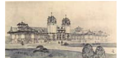
明治神宮宝物殿コンペ応募案(佳作三席) | 日本で行われた最初期の本格的なコンペ。明治神宮の境内という環境に対応し、かつ耐震耐火の建築が求められたことから、RC造による伝統表現の可能性を問うコンペとなった。最終的には、当選案を参考にして神宮造営局の大江山太郎が実施設計を担当した[出典：「明治神宮宝物殿競技設計図集」[洪洋社/1915]]
