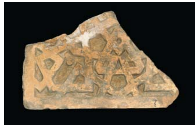
浮彫無釉レンガ:レンガに立体的な文様を施すのも地域の特徴的なもの。幾何学と陰影が織り物のように建築表面を覆う [12世紀/340×520×40mm/ウズベキスタン、ブハラ]
