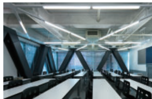
左—学生サロン 南、北西、北東に位置する3層吹抜け空間（27階南側） 上—モード学園コクーンホール Aホール（448人収容） 下—一般教室 照明も構造のダイアゴナルフレームに合わせて設計
